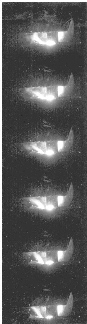
Рис. 2. Инограмма процесса сварки составным электродом в аргоне: интервал между кадрами 6 \cdot 10^{-4} с; направление сварки – слева направо
